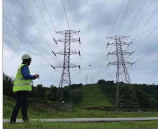
一名技术人员正在操作无人机，航拍图像数据观测任务，研究拟建的新输电线路。
