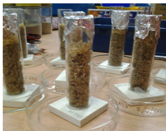
(d) Arrangement of timber specimens for EN118 test
