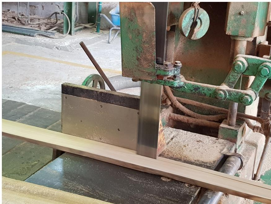
**Gambarajah 5** Pemotongan *flitches* kepada *sticks* menggunakan mesin gergaji gelung
