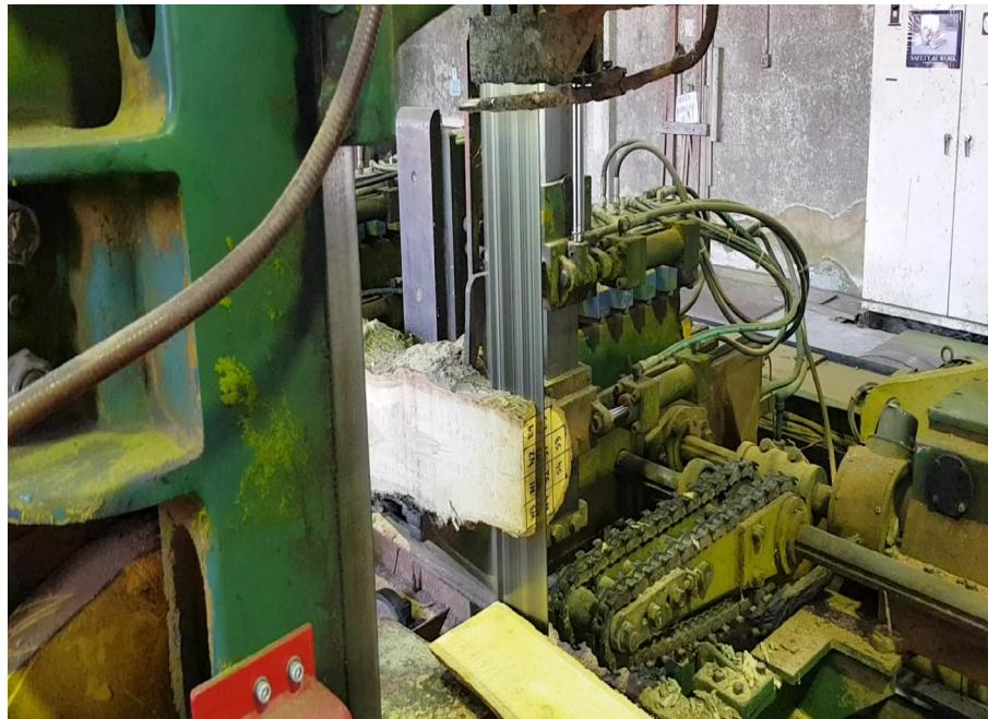
**Gambarajah 4** Proses pemotongan tual kepada *flitches* menggunakan mesin gergaji gelung
